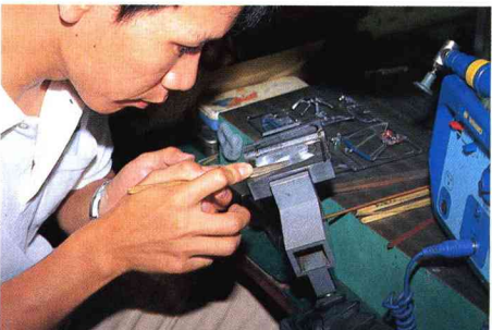
細く短冊にした極細目のサンドペーパーで、ウインドー部分（透明部品）の型の鏡面仕上げをしているところ。プラモデルの製造現場でも今日では高度なNC化が進んでいるが、最後の最後に至る仕上げは、人の手で行われる。
