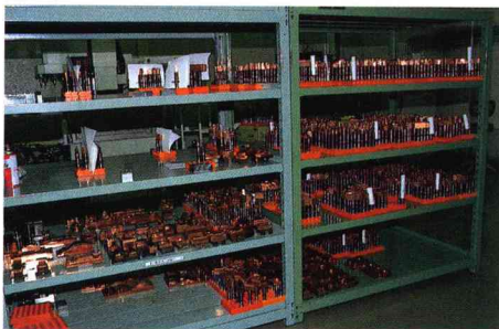
並べられた電極の数々。ひとつのキットを仕上げるまでには、400～500種類の電極が使われる。電極そのものもNC切削やワイヤーカット、鍛造などの技術を駆使して加工される。
