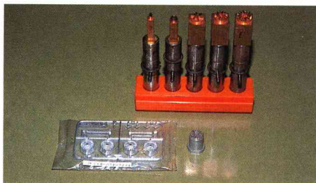
自動車のアルミホイール用の型（手前右）を造るために、5種類の電極が順に組み合わされる。
