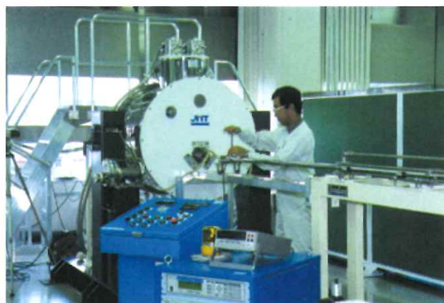
12テスラの超電導磁石を用いた強磁場利用プロセス。強磁場中での加熱冷却、加工ができる (JRCM/川崎製鉄)。
