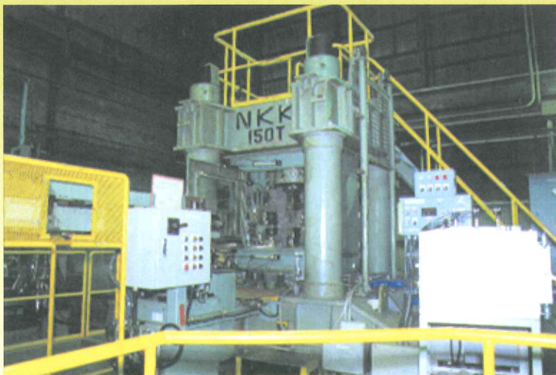
150 トンTMT シミュレーター。加熱冷却も含め大ひずみによる試料を作成するとともに、データ収集を行うことができる (JRCM/NKK)。
