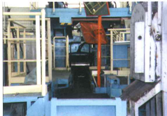
規模の大きな大ひずみ加工を可能にした1000トン圧延実験機。圧延工程のすぐ後ろに水冷装置が取り付けられ、大ひずみ加工と急冷を組み合わせることができるよう改良されている。実生産規模に近い大きさの試料を作製することができる（JRCM／新日本製鐵）。
