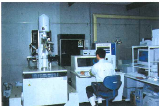
スーパーメタル・プロジェクトで導入されたインレンス方式の走査型電子顕微鏡。これまで鉄鋼のような強磁性材料では不可能と考えられてきた磁界レンズの中央に試料を配置するという方法を可能にしたことで、1nm オーダーでの鮮明な画像が得られるようになった (JRCM/ NKK)。
