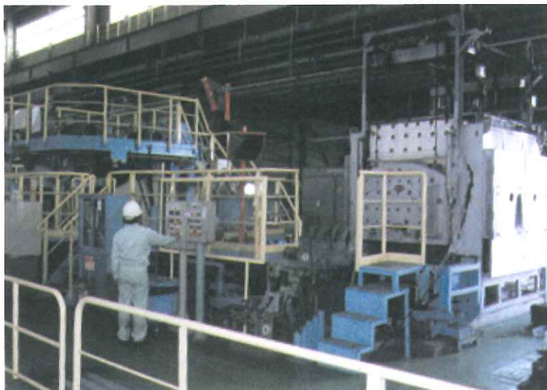
規模の大きな大ひずみ加工を可能にした1000トン圧延実験機。圧延工程のすぐ後ろに水冷装置が取り付けられ、大ひずみ加工と急冷を組み合わせることができるよう改良されている。実生産規模に近い大きさの試料を作製することができる（JRCM／新日本製鐵）。
