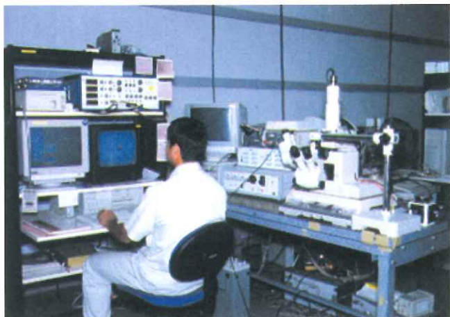
研究者の「手づくり」で組み立てられたプロジェクト初期のナノインデンテーション（金材技研）。
