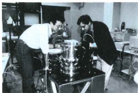
NASDAで開発された静電浮遊炉の地上用設備。試料を静電浮遊させ、レーザーにより溶融させる。
