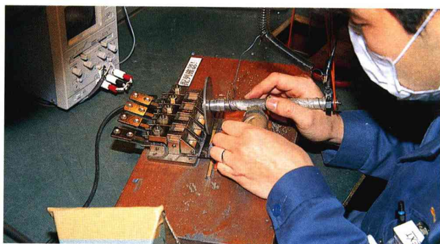
歯の調律。熟練作業によって音が合わせられる。銅製の歯のうち低音域には鉛のウェイトがつけられている。
