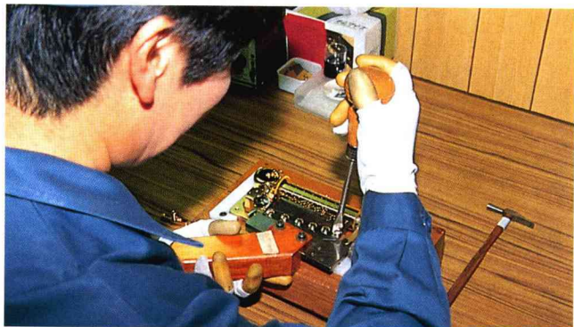
シリンダーと歯の位置合わせ。上位機種では手作業で取り付け位置が微妙に調整される。
