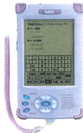
無線LANを搭載しているWEB型端末。バーコードスキャナで情報を瞬時に読み込み、無線でサーバーへ送信、回答がただちにブラウザ内に表示される。
