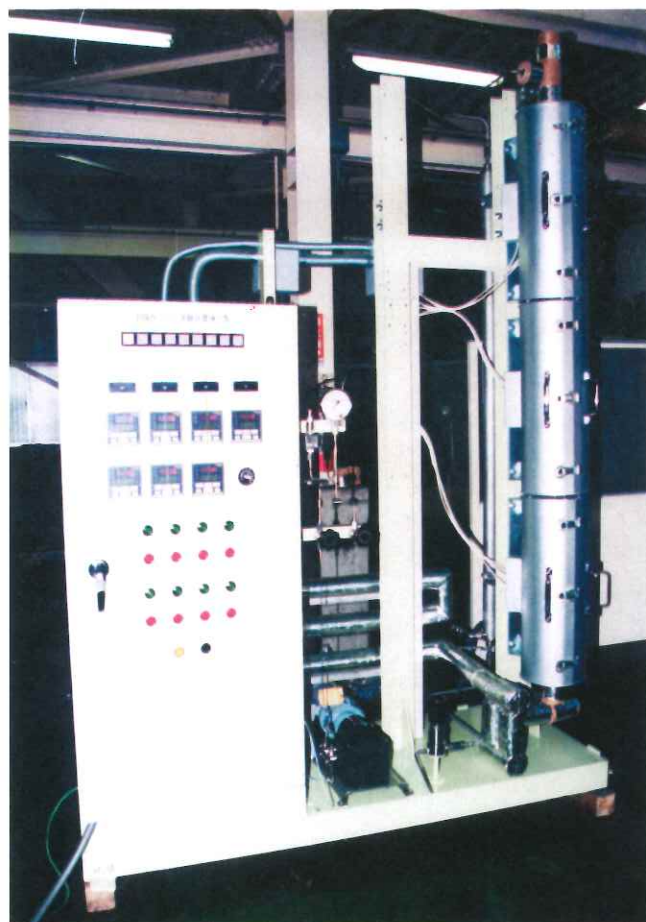
図4／超臨界水実験装置の実験モデル。TDA回収プラント内にこれと全く同じものが使用されている。
