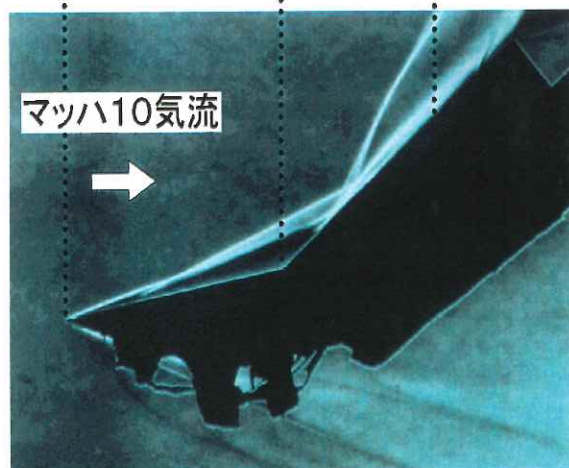
マッハ10の気流下でも、感圧塗料は計測が可能である。期待される次世代航空機の開発などにおいても活躍が予想される。（下図＝試験模型に気流をあてているところ、上図＝計測されたデータ）
