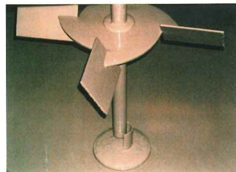
ライザー管内を循環する泥水は、掘削している地層や深度に応じて比重や粘性、化学組成などを微調整して用いる。写真上部に見える羽根は攪拌機のもの。
