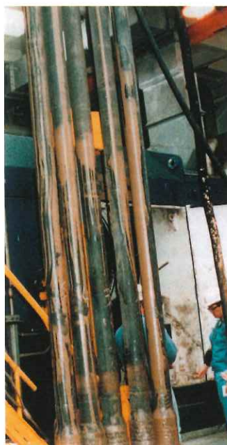
ドリルパイプの強度も計画実現の鍵を握る重要なファクターである。なお、ドリルパイプ先端にあるドリルビット（PDC コアビット）はチタン合金と工業用ダイヤモンドなどで構成され、ドリルパイプの回転とは別に水圧で駆動・回転する構造となっている。
