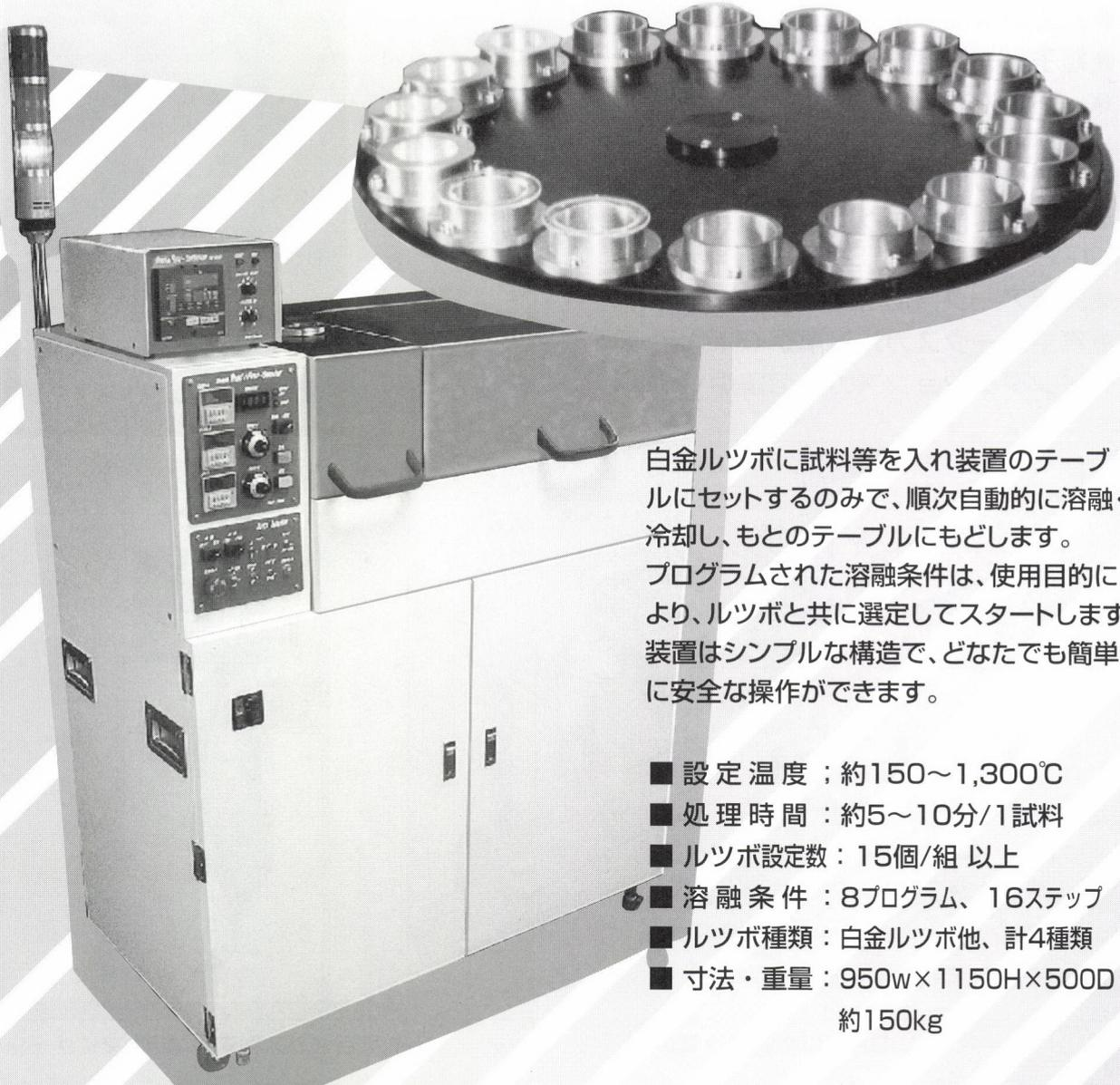
白金ルツボに試料等を入れ装置のテーブルにセットするのみで、順次自動的に熔融・冷却し、もとのテーブルにもどします。プログラムされた熔融条件は、使用目的により、ルツボと共に選定してスタートします。装置はシンプルな構造で、どなたでも簡単に安全な操作ができます。
