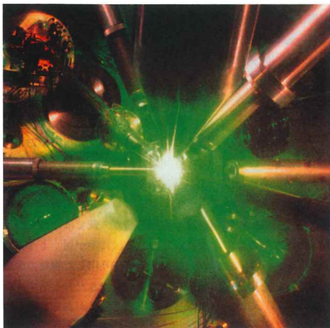
大阪大学がレーザー核融合用に開発した「激光-XII」。試料にレーザーを照射すると、プラズマが生じ、これがレーザーと相互作用し試料を強く圧縮する。
