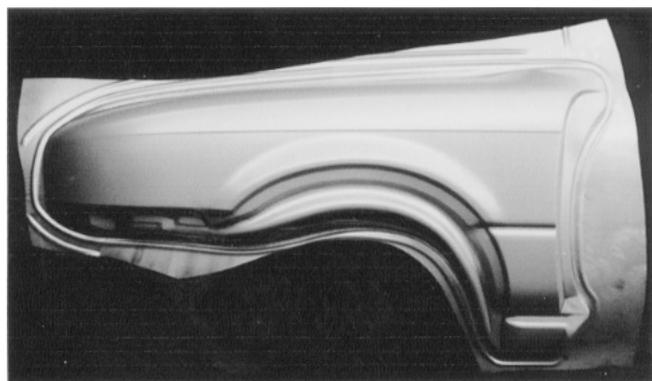
SFG440-GA をプレス成形したフロントフェンダ試作品
