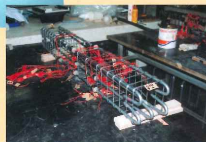
TRIP鋼鉄筋の試験用サンプル(左)と鉄筋コンクリート梁の模型(右)
