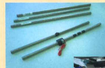
TRIP鋼鉄筋の試験用サンプル(左)と鉄筋コンクリート梁の模型(右)
