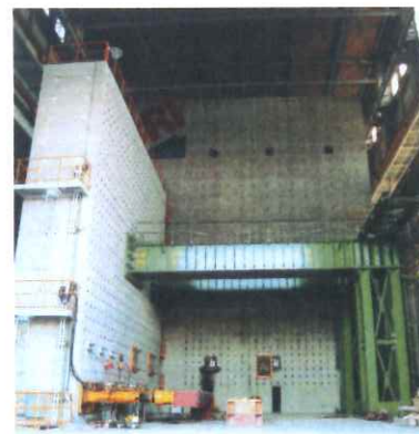
世界最大級の実大構造物実験設備では7階建ての構造物の設置が可能(建築研究所)
