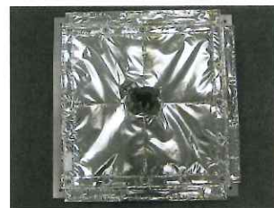
約1cmの模擬デブリを秒速5.71kmで衝突させた後のバンパーとスタッフィング (宇宙開発事業団によるバンパーの高速衝突試験結果)
