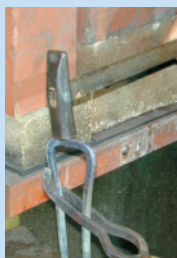
①鉄の丸棒を叩いて曲げ、キーボウの形を成形する。
