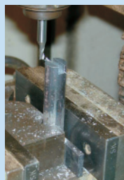
④やすりで仕上げた後、キーボウとの接合部に溝を入れる。
