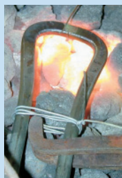
②キーボウの接合部を蝋付けし、やすりで仕上げる。
