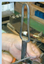
⑥蝋付けの後やすりで仕上げ、ウォードを作る。
