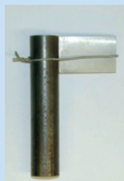
③成形したキーシャングとキービットを固定し、蝋付けする。
