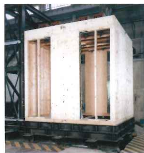
耐力壁加振試験（（社）鋼材倶楽部（当時）と建築研究所の共同開発）
