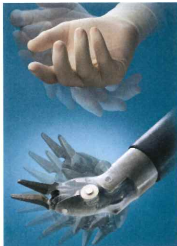
「ダビンチ」の先端部には2つの関節があり、人間の手指のような動きが可能となる。
