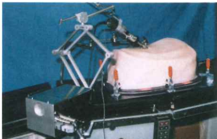
東京大学大学院情報理工学系研究科の土肥健純教授らのグループが開発した内視鏡(腹腔鏡)マニピュレータ「ラバロナビ」。安全性、洗浄、滅菌および操作性といった手術支援ロボットの重要な条件を満たしている。
