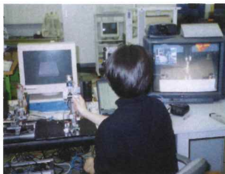
東京大学大学院工学系研究科・光石研究室が行った多次元ジョイスティックを用いた遠隔手術実験。
