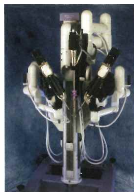
最新鋭の手術支援ロボット「ダビンチ」。術者はコンソール(操作ボックス)に座り、高解度3次元画像により術野を観察できる。アーム・ユニットは内視鏡と鉗子を持つ3本のアームを持つ。
