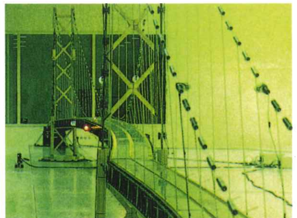
1991年に幅41 m、長さ30 m、高さ4 mの大型風洞施設が旧建設省・土木研究所敷地内に建設され、明石海峡大橋の全橋模型による風洞実験が行われた。
