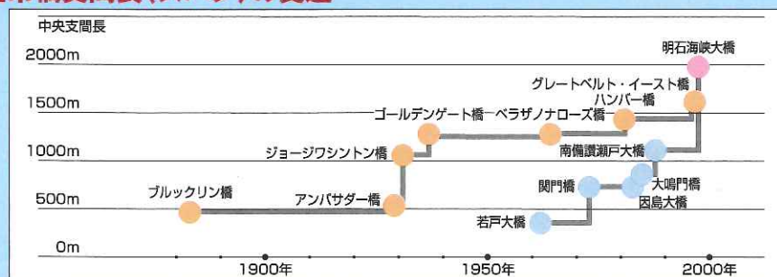
明石海峡大橋のスパンは世界最長の1,991m、主塔の高さも102階建てのビルに匹敵する約296mあって、風に対する徹底した対策がとられた。
