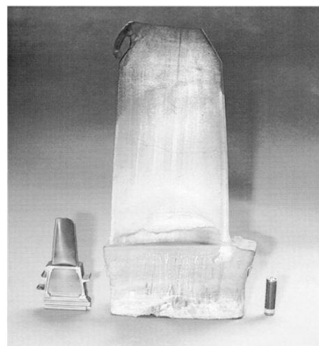
図8 第3世代TMS-75による15MW発電ガスタービン第一段単結晶動翼(左:実機試験中)と200MW級第一段単結晶動翼(模擬翼)
