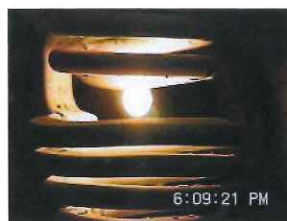
電磁場の中で浮遊したシリコン液滴
