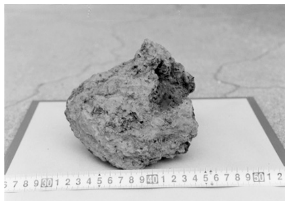
写真3 畑で採取される鍛冶滓
