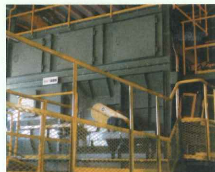
強力磁石で鉄と非鉄金属を分離する磁力選別機
