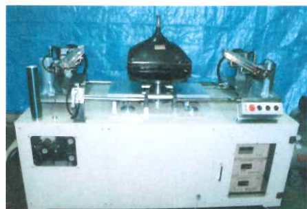
ハロゲンランプの輻射熱を利用した集光式CRT分割装置
