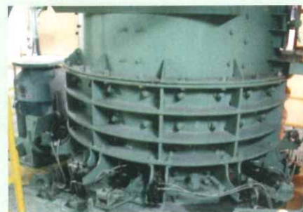
廃家電を破碎する340馬力の縦型破碎機
