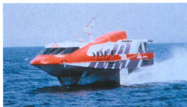
水中翼の揚力を利用したTSL-F実海域模型船「疾風」(全長約17m、全幅約6m)
