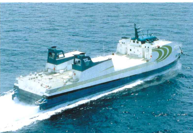
空気圧力を利用したTSL-A実海域模型船「飛翔」 (全長約70m、全幅約18m)
