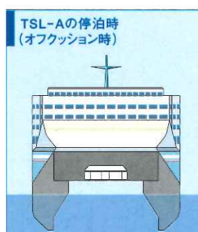
高速浮上航行時には船体下部に空気を噴出し、船体と前後の軟式構造のシールで空気を閉じ込め船体を浮上させ、水の抵抗を大幅に低減させる
