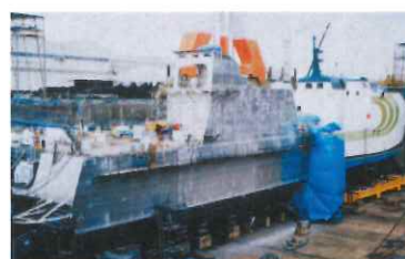
TSL-Aの船体の前半部と後半部の接合工程、船殻には耐食アルミニウム合金を使用
