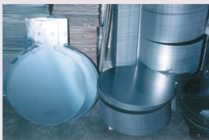
①まずは中華鍋の原型となる鉄板をプレスカッターで型抜きする。原材料の鉄板は厚さ1.2mm
