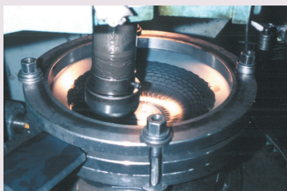
②型抜きした鉄板をプレス機で中華鍋の形に成形し、打出し機を使って打出しをする。その際、鍋の内側に油を塗り、油が作る模様を見ながら鉄板を薄く叩いていく
