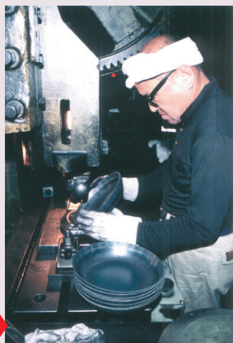
③プレスの湾曲成形でできた平たい縁を別のプレス機にかけて「縁起こし」を行う。その際に生じた皺は職人が中華鍋を手で回しながら自動ハンマーで叩いて伸ばす
