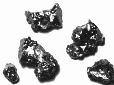
図8 カソード析出した金属塊の例
