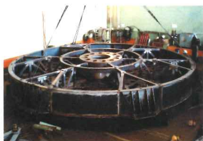
板の平坦度、溶接品質、仕上がり寸法など、極限の鉄鋼技術が生かされた主鏡セル
