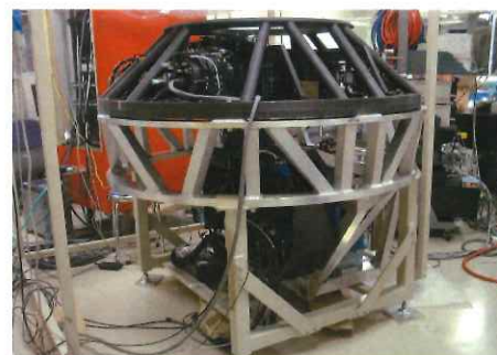
コンピュータ技術を駆使して像の乱れを補正する波面補償光学装置
