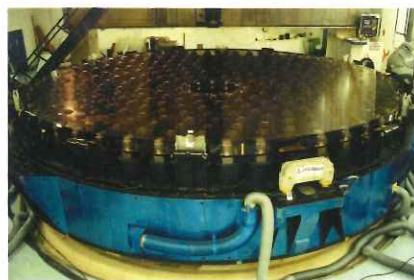
巨大な主鏡は主鏡セルの上に載せられ表面蒸着を待つ
