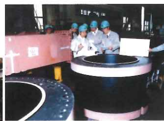
望遠鏡の中で最も大きな力を支える鏡筒の回転軸部品(鍛造材)
