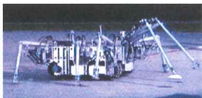
蜘蛛(クモ)のような外観の地雷探知ロボット「COMET-III」 (写真提供:千葉大学工学部・野波健蔵教授)
