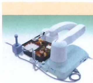
手の不自由な人でもわずかな操作で食事のできる介護用ロボット「マイスプーン」 (写真提供:セコム(株))
