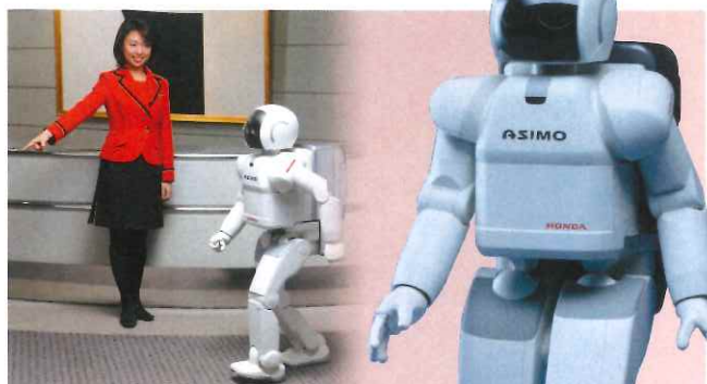
人間の生活空間で活動することを想定して開発された人間型ロボットの「ASIMO」は、人間の顔の輪郭を判断できるなど、高知能技術が投入されている。 主な仕様:身長120cm、体重52kg、最高歩行速度1.6km/h、握力5N/hand (写真提供:本田技研工業(株))
