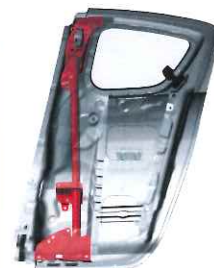
側面衝突対策のため後部ドア内部に高張力鋼管を組み合わせた「RX-8」(写真提供: マツダ(株))
