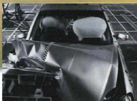
オフセット衝突試験のようす
