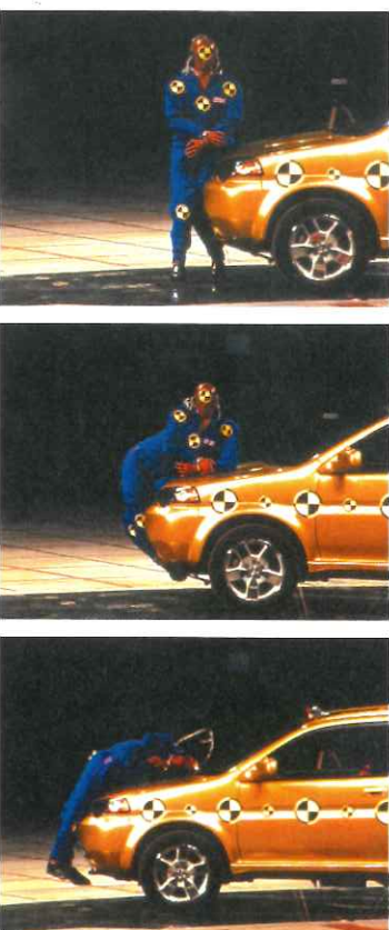
歩行者保護の衝突試験の連続写真(上から下へ)。最初にダミーの足がフロントバンパー部分に当たり、足がすくわれた後、頭部がフード部分に衝突する(写真提供: 本田技研工業(株))
