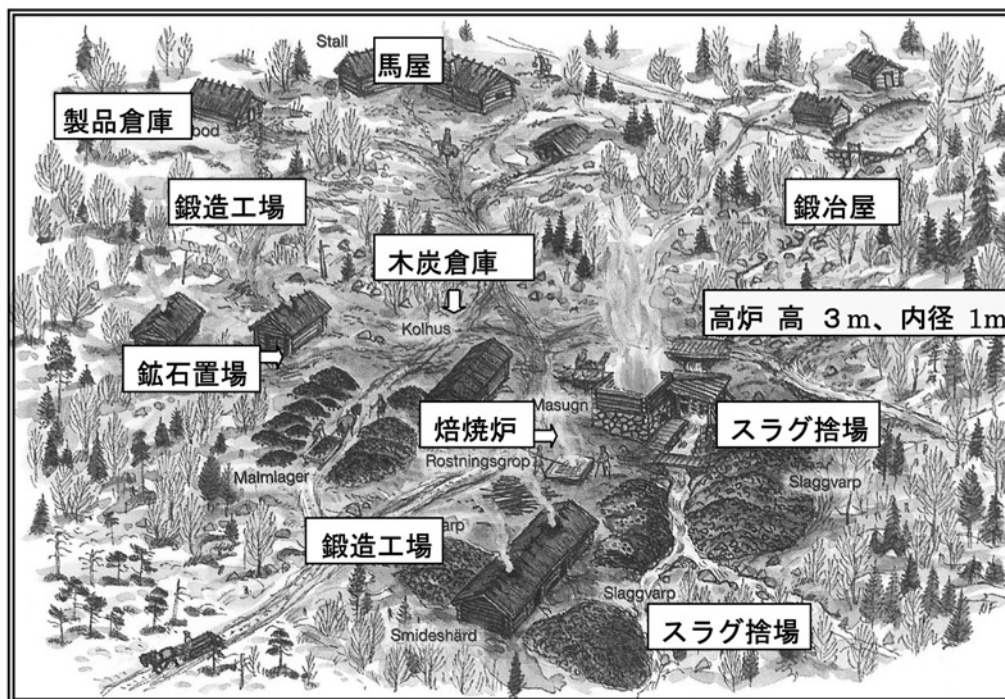
Fig.9 Lapphyttan 一貫製鉄所の復元想像図 28)
