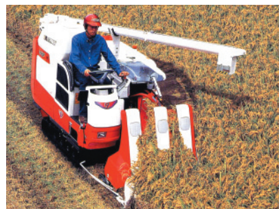
稲の刈り取りから脱穀および選別までを機械化したコンバイン (写真提供:ヤンマー農機(株))
