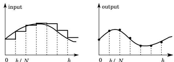
図8 FSFHによる連続時間入出力信号の離散時間近似
