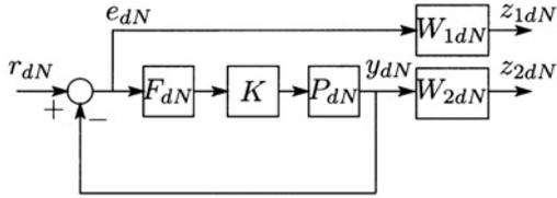
図9 FSFHによる近似離散時間系
