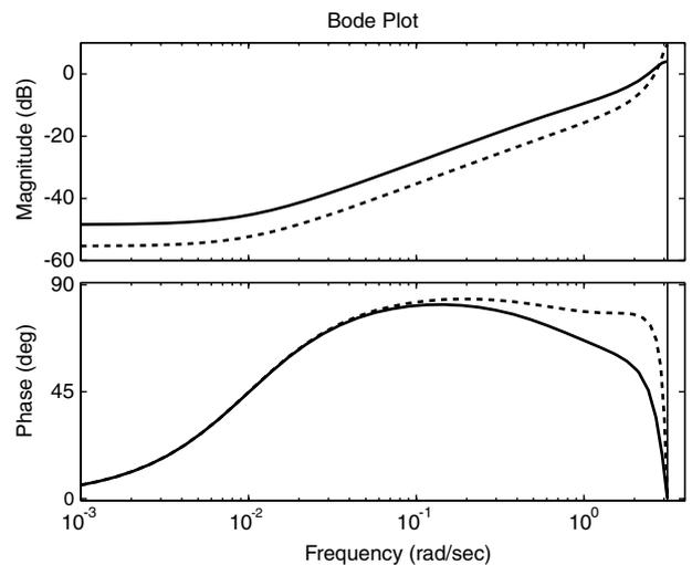
図10 コントローラのボード線図
