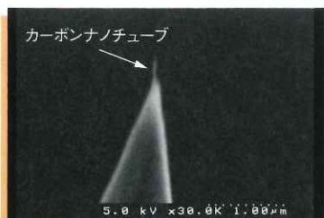
シリコンの探針に堆積したニッケルを触媒とし、アセチレンの混合ガスを用いた気相成長によって、カーボンナノチューブが形成できる。この際、基板に電圧を印加して探針先端部に電界を集中させることにより、カーボンナノチューブを探針の先端から選択成長させることができる。これをSPMの探針や、電子顕微鏡の電子源に適用する研究が行なわれている。(写真提供:東北大学、江刺・小野研究室)
