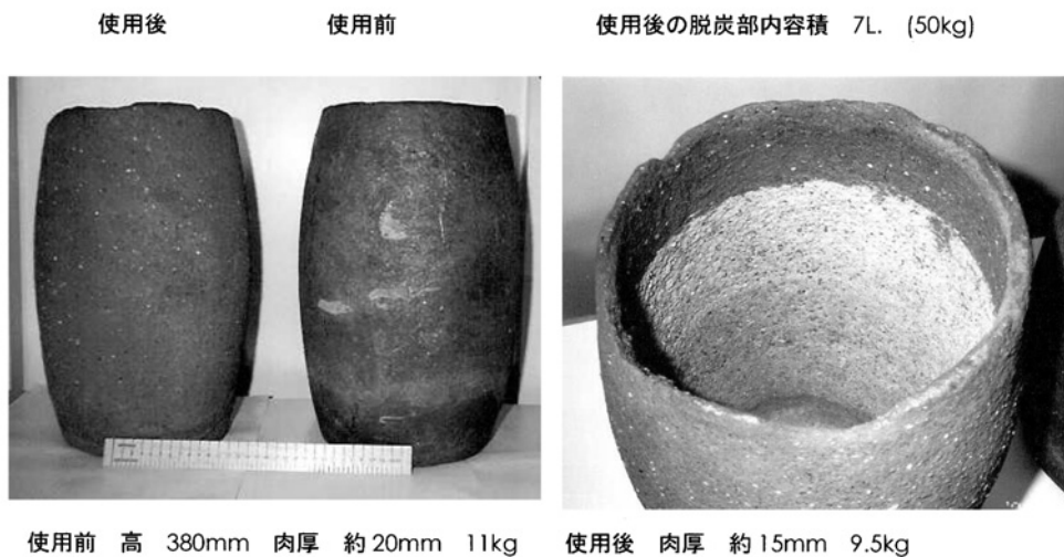
Fig.2 1937年まで日本特殊鋼で使用された製鋼用黒鉛ルツボ
