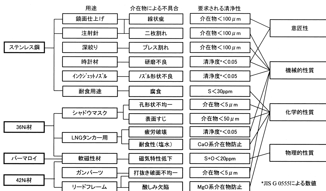
図1 高潔淨化のニーズがある鋼種群と要求される潔淨性
