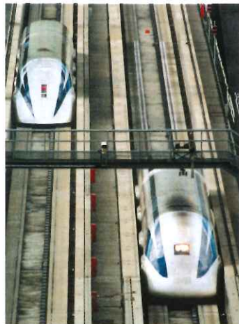
高速すれ違い走行試験で相対速度1003km/hを記録(1999年、山梨実験線)
