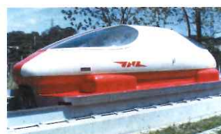
1972年、超電導磁石を用いたリニアモーター推進により、世界初の電磁誘導浮上走行に成功(ML100 東京)
