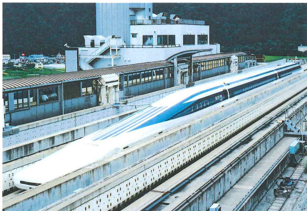
極めて長い先頭形状を持つ山梨実験線新型車両は、500km/hという超高速域における空力特性の向上を追求している。
