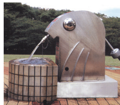
ポンプカバーを付けた深井戸用ポンプ。公園や小学校などで親しみやすい水辺を演出している。
