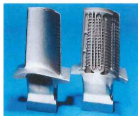
単結晶合金によるタービン動翼(右側は内部で、複雑形状をした冷却空気通過部分がわかる)
