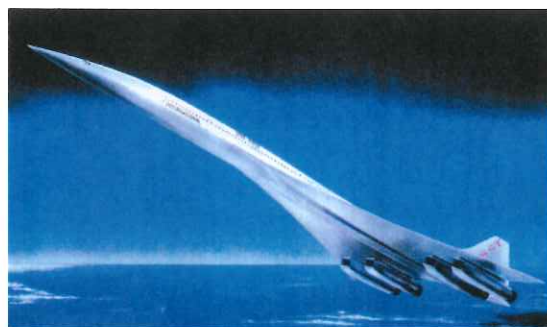
HYPRプロジェクトでは、ラムジェットとターボジェットを組み合わせたコンバインドサイクルエンジンを試作、システム実証研究が行なわれた。写真は次世代超高速旅客機のイメージ(左上)、コンバインドサイクルエンジンのイメージ(左下)、エンジン性能実験風景(右下)(写真提供:新エネルギー・産業技術総合開発機構)
