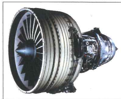
B777などの民間航空機用に開発、量産された大型エンジンのGE90
