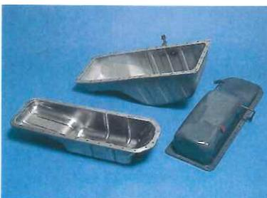
オイルパンに制振鋼板を使用することにより、3~4dB(近接)の騒音低減効果を発揮する
