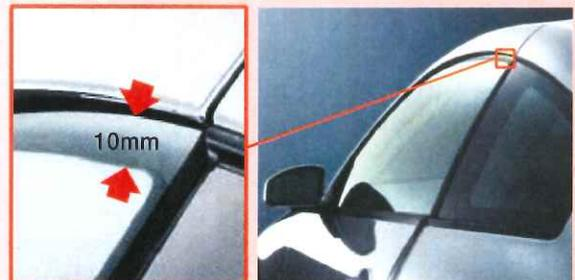
ドア開閉時にガラスを約10mm下降させ、ドアを閉じた後上昇させる機構により、ドアを閉じる時の空気圧の影響を減少させている。この機構はウェザーストリップとガラスとのシール性を向上させ、高速走行時の吸い出し音をなくす効果もある。(写真提供:日産自動車(株))
