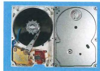
HDDは、シーク音と呼ばれる読み書き時のヘッドの駆動音やディスク高速回転に伴う風きり音等が発生するが、これらの音(振動)を低減するためカバーに制振鋼板が使用されている
