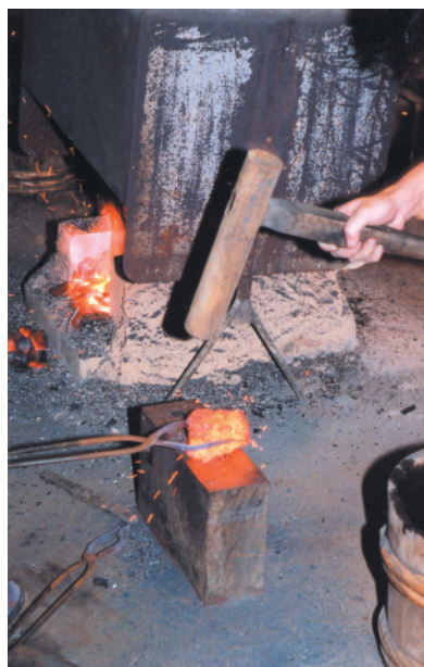
焼き上がった玉鋼は白熱温度(1200度から1350度)から赤みの消える温度(約600度)以下の温度(400~500度)に下がるまでに、素早く金槌によって鍛えられていく。
