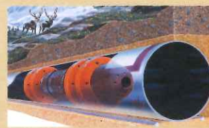
超音波検査ピグ (パイプライン内を移動しながらパイプの腐食を超音波により検査する装置)
