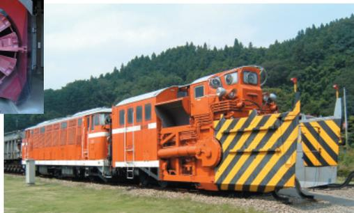
ラッセル車が押し退けた雪の壁を拡げる役割を担うロータリー車
