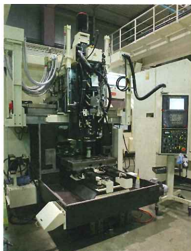
小型機種の組み立て途中の姿。主に金型加工などに使われる縦型のマシニングセンタで、ブリッジ状の摺動部に、スピンドルが垂直に装着される。左写真がスピンドル部装着後。
