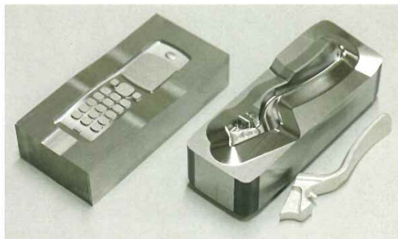
携帯電話の筐体の樹脂用金型と、機械のグリップ部品の金属鍛造用金型。金型を最終工程まで切削加工するニーズが高まっている。
