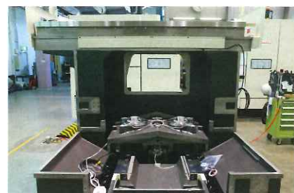
小型機種の組み立て途中の姿。主に金型加工などに使われる縦型のマシニングセンタで、ブリッジ状の摺動部に、スピンドルが垂直に装着される。左写真がスピンドル部装着後。
