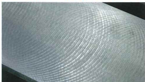
キサゲ加工前の、機械加工のままの表面（写真は大型機種のテーブル表面）。この段階で平面性には最大5 \mu m程度の誤差がある。
