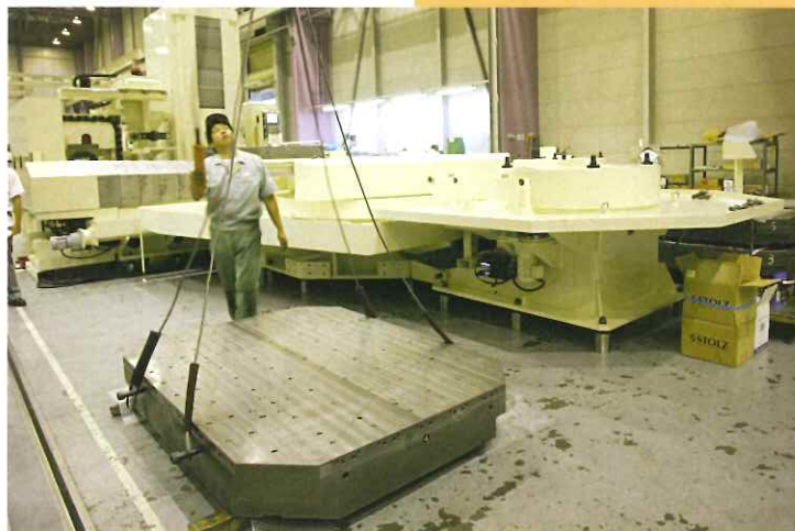
大型機種の最終組み立て作業。据え付けようとしているテーブルが、左写真でキサゲ加工していたのと同じもの。
