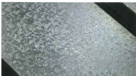
キサゲ加工後。最終的には、1インチ平方の中に、定盤を摺り合わせて当てる「山」が20か所くらいになり、平面性の誤差は2 \mu m以下になっている。
