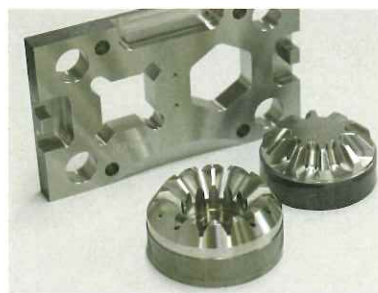
高硬度材料加工見本。手前は自動車のギア部品で、ロックウェル硬度60を超えるが、これらも仕上げまで切削で作ることができる。
