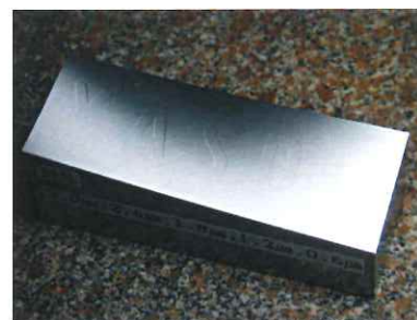
精細段差加工見本。一見ただの金属ブロックに見えるが、表面には順に1.5~0.3μmの段差で「YASDA」の文字が彫り込んである。
