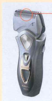
カミソリ刃のステンレス基材の表層に高硬度金属間化合物を組合せ、密着度の高い傾斜組成構造とした。 (写真提供:松下電工㈱)
