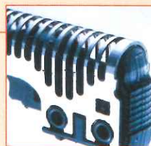
カミソリ刃のステンレス基材の表層に高硬度金属間化合物を組合せ、密着度の高い傾斜組成構造とした。 (写真提供:松下電工㈱)
