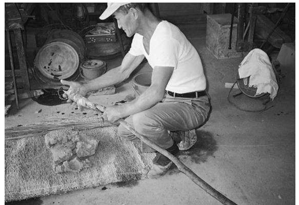
写真3 トメ棒の作成（滋賀県西澤梵鐘鑄造所）
