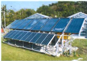
必要なエネルギーのすべてを太陽エネルギーでまかなう自立型海水淡水化装置 (写真提供: (株) 荏原製作所)
