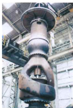
世界最大の多段フラッシュ海水淡水化プラント(2003年3月竣工)に使用されたブライン再循環ポンプ
