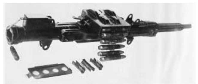
図7 ベルト給弾方式の20mm4型機関砲 13)
