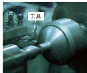
切削に使用する工具はこの3本のみ。砲丸の曲面にならって少しずつ切削していく。
