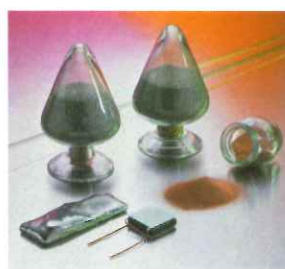
水素の吸収、放出特性を生かして水素貯蔵への応用が検討されている水素吸蔵合金 (写真提供: (株)日本製鋼所)
