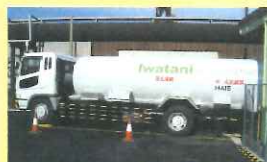
液体水素を運搬する液体水素ローリー
