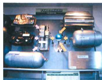
カーボン繊維強化プラスチック複合材とアルミニウムを一体化した車載用圧縮水素ガスタンの例(1999年東京モータショー展示より)
