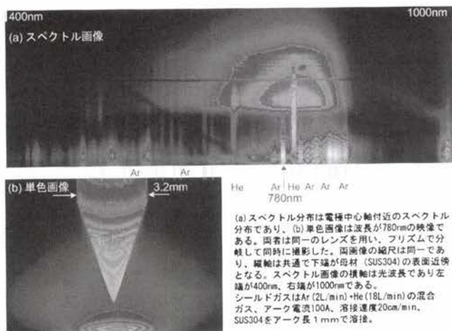
図2 ティグアークのスペクトル分布 シールドガス=Ar (2L/min) + He (18L/min)、アーク電流100A、 溶接速度20cm/min、SUS304を溶接
