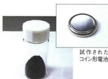
\text{Li}_{0.44}\text{Mn}_{0.78}\text{Ti}_{0.22}\text{O}_2 開発されたリチウムマンガン酸化物チタン置換体の黒色粉末
