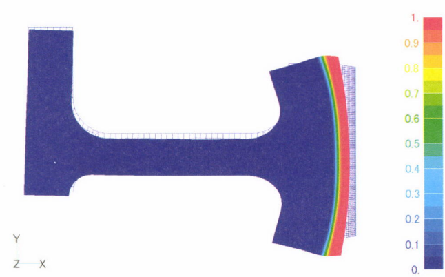
図15 IHQシミュレーション事例(マルテンサイト分布と変形/拡大表示)
