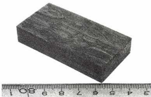
図4 錨鎖材の鋼材試験片のマクロ組織（鍛造材）
