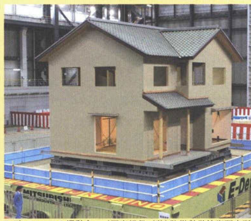
E-ディフェンスの振動台（写真提供：（独）防災科学技術研究所）
